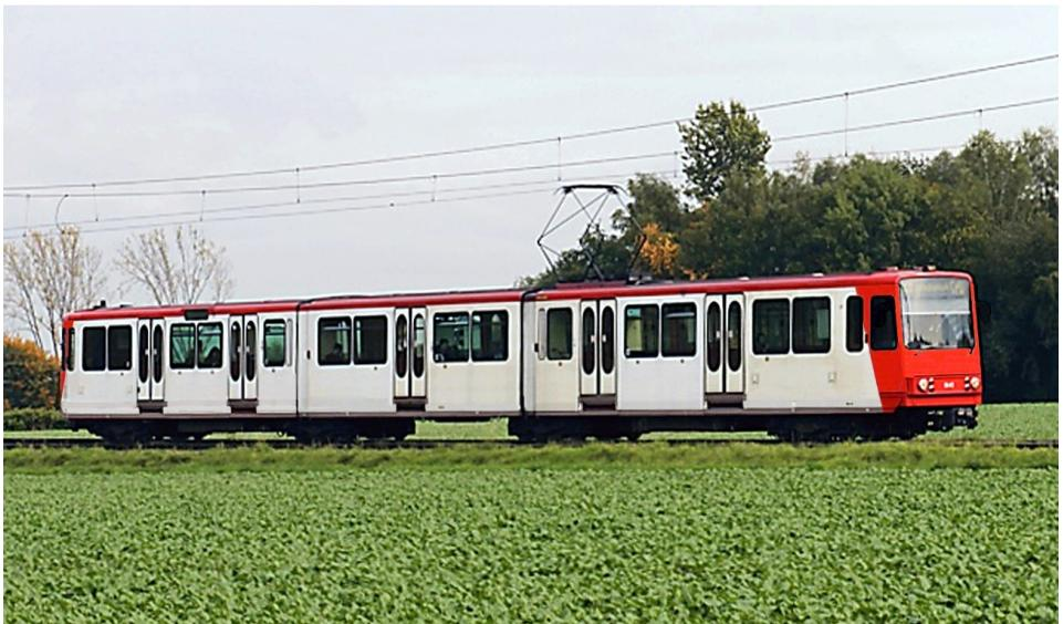
Das Einfügen eines 10 Meter langen Mittelteils erhöht die Kapazität des B-Wagens um 37% = 28 Sitz- und 80 Stehplätze. Offiziell heißt der 38 Meter lange Achtachser B80C/8 – die *VS-NF* nennt ihn aber C-Wagen, weil dieser einfachere Begriff anderweitig nicht verwendet wird.
