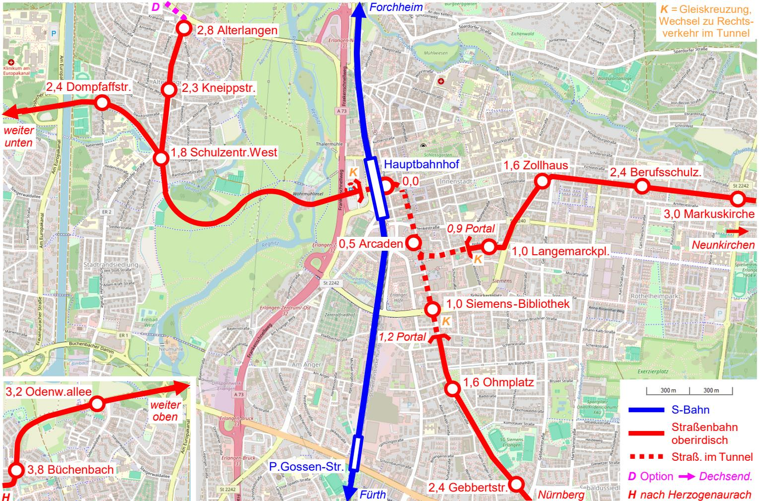
Der Gleiswechsel erfolgt nicht mit einfachen Kreuzungen, sondern mit zwei Weichen und einem dazwischen liegenden eingleisigen Abschnitt. Man kann dadurch auch weiter fahren, wenn bei Störungen oder Bauarbeiten ein Gleis gesperrt wird.
