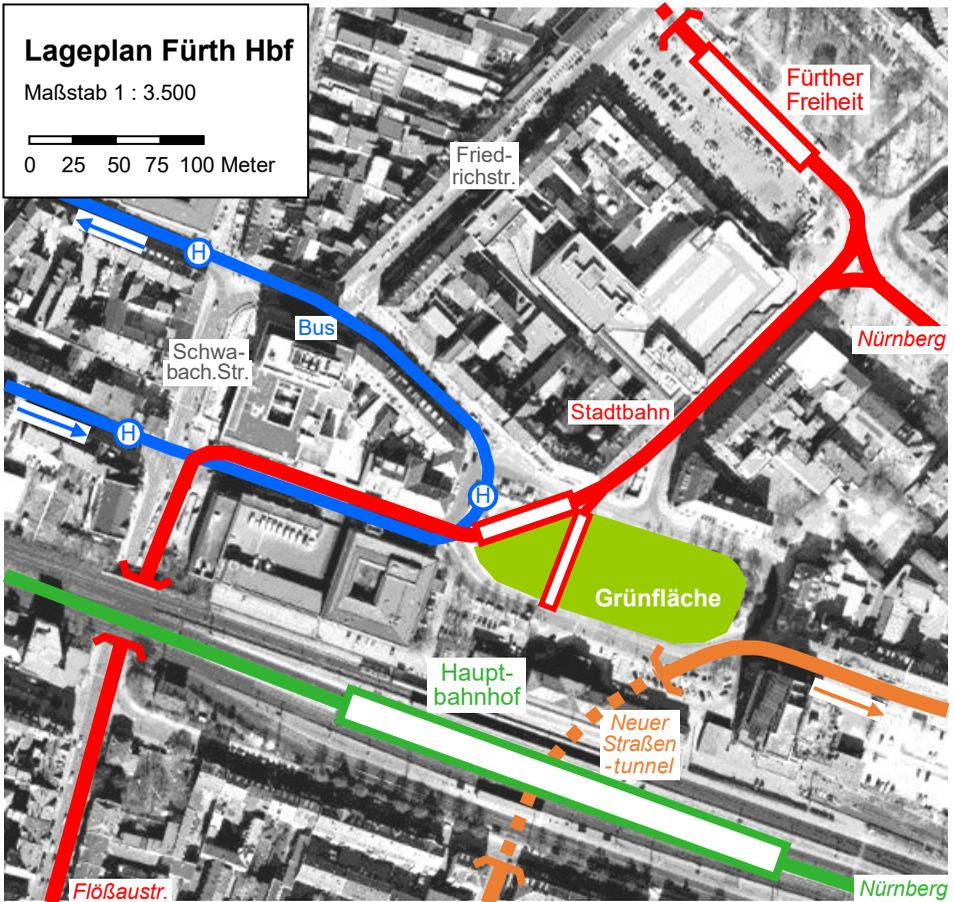
Die VS-NF hätte (wie in der Realität) neben der Hauptpost eine neue Verbindung vom Bahnhofplatz zur Schwabacher Straße gebaut und in der Nordhälfte ein Gleispaar verlegt. Der Gleisweg wird etwa 100 Meter kürzer, der engste Kurvenradius wächst von 25 auf 40 Meter und die Stadtbahn kommt 1 bis 2 Minuten schneller voran.
