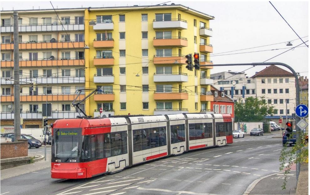
*2007 bis 2009 kaufte die VAG Nürnberg acht Variobahnen bei der Firma Stadler. Das Nürnberger Modell GTV6 besteht aus 5 Modulen, ist 33,94 m lang und 2,30 m breit. Die VS-NF hätte ab 2014 für Erlangen ähnliche Straßenbahnen beschafft, für mehr Komfort wären sie aber 5 bis 10 cm breiter. Den Gleisabstand hätte man bei den 36 Neubau-km ab 1985 und der Modernisierung von 15,4 Bestands-km schon angepasst. (Triebwagen 1208 am Kohlenhof, © 29.9.17 Jörg Schäfer)*
