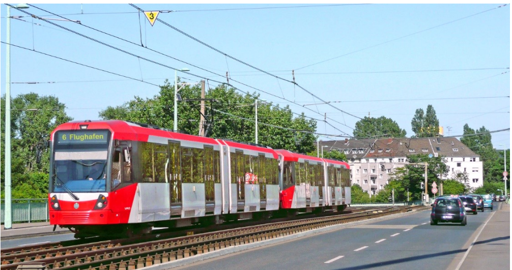
Fotomontage einer Doppeltraktion von zwei D-Wagen. Im Gegensatz zur U-Bahn muss man den Gleiskörper der Stadtbahn nicht hermetisch abriegeln.
